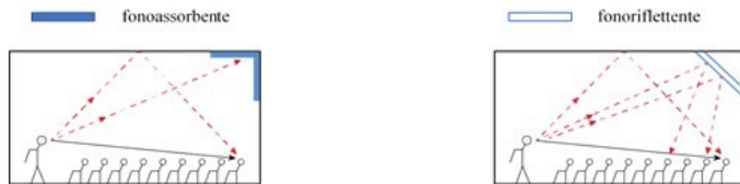
Figura 5. 17 - Esempi di collocazione di materiale fonoassorbente e fonoriflettente sulla parete di fondo e la parte posteriore del soffitto in un'aula scolastica di grandi dimensioni.
